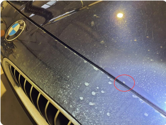
1.1 Noe steinsprut med rust
